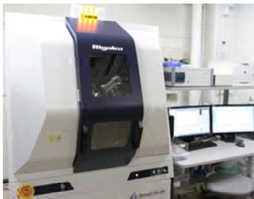
平成23年度教育研究等重点推進経費で採択された本装置は、回転対陰極式線源 (Cu, 45kV, 200mA) を用いて強力なX線を照射し、試料から生じた散乱、回折X線を測定します。特に薄膜試料に威力を発揮します。インプレーン測定をはじめ膜厚測定、配向測定、粒径空孔径分布測定、ロッキングカーブ測定が可能な多目的測定装置です。ガイダンス機能により、測定条件の設定などが自動的に行われるため初心者でも容易にデータを得ることができます。X線入射源にはGe二結晶、四結晶が選択でき高分解能測定が可能です。また、シンチレーション検出器と数分で高速測定が行える一次元検出器が用意されています。さらに、ICDD (Ver2.1102) も搭載されています。
