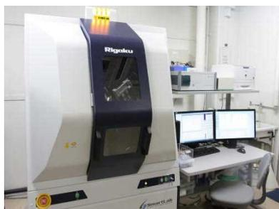
SmartLab は、回転対陰極式線源 (Cu, 45kV, 200mA) を用いて強力なX線を照射し、試料から生じた散乱、回折X線を測定します。特に薄膜試料に威力を発揮します。今回、大阪大学科学機器リノベーション・工作支援センターの平成26年度リユース促進経費で微小部測定ユニットが導入されました。
