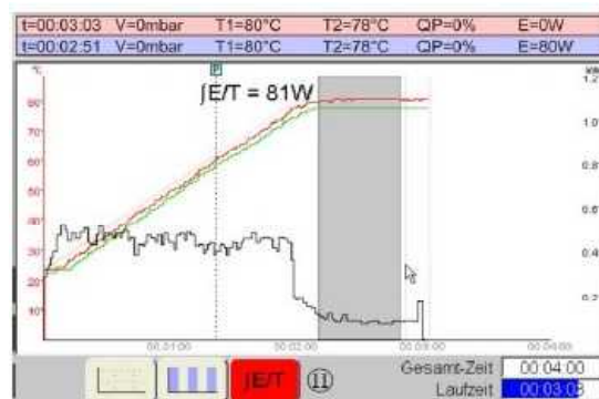
内部温度センサー、外部温度センサーによる反応温度制御
