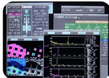
EPMA (Electron Probe Micro-Analysis) はLaB<sub>6</sub>電子銃により発生した電子線を数十nmに細く絞り最大40kVまで加速し固体試料表面に照射します。発生する特性X線の波長により試料を構成している元素を同定し定量分析まで行えます。元素分布状態を知ることの出来るマッピング測定、線分析も可能となっております。測定元素範囲はB～Uまでで8分光結晶、4検出器が装備されています。本装置の特徴の一つとしてカソード・ルミネッセンスも測定が行えます。金属・鉱物・セラミックスをはじめ半導体材料の評価に威力を発揮します。
