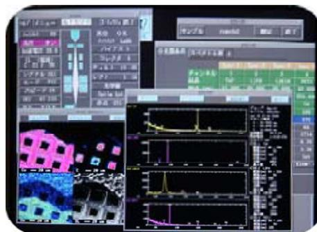
EPMA(Electron Probe Micro-Analyser)はLaB<sub>6</sub>電子銃により発生した電子線を数十nmに細く絞り最大40kVまで加速し固体試料表面に照射します。発生する特性X線の波長により試料を構成している元素を同定し定量分析まで行えます。元素分布状態を知ることの出来るマッピング測定、線分析も可能となっております。測定元素範囲はB～Uまでで8分光結晶、4検出器が装備されています。本装置の特徴の一つとしてカソード・ルミネッセンスも測定が行えます。金属・鉱物・セラミックスをはじめ半導体材料の評価に威力を発揮します。
