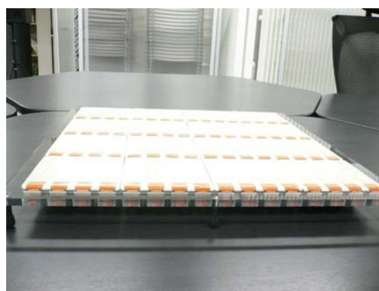
図4 自己組織化ネットワークシステムと一体化した大面積センサシステムの一例
