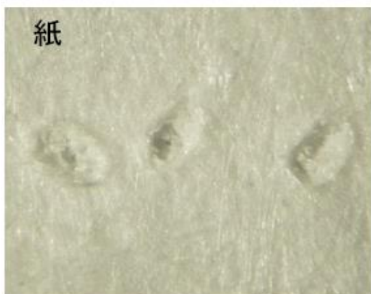
図2. 集光した THz FEL による大気のブレイクダウンと照射による物質の変化
