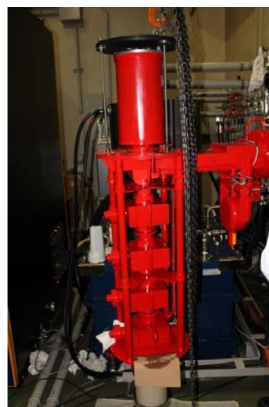
図2 作業のために引き上げられたクライストロン。正面下側の茶色の吸引紙が漏れた冷却水で変色しているのが見える。
