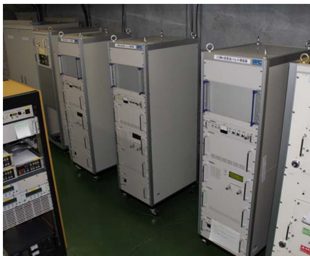
図4 新たなサブハーモニックバンチャー用高周波源となる 3 台の半導体パルス増幅器。奥の 2 台が 108MHz 空洞用、手前側が 216MHz 空洞用。
