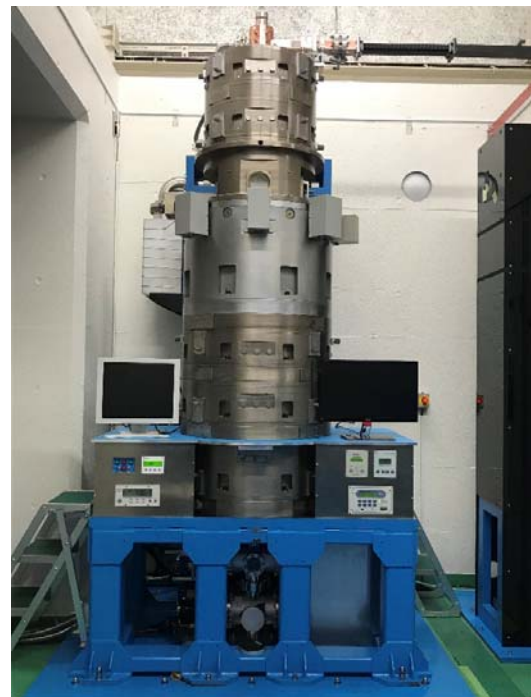
図 1 新たに開発したフォトカソード RF 電子銃を用いたフェムト秒時間分解電子顕微鏡
