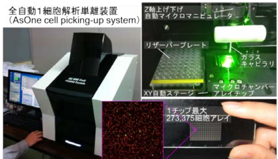
図1 全自動1細胞解析単離装置と装置内部の構成
