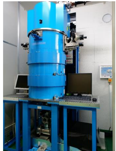
世界初の相対論的フェムト秒電子線パルスによる「超高速電子顕微鏡」実証機
