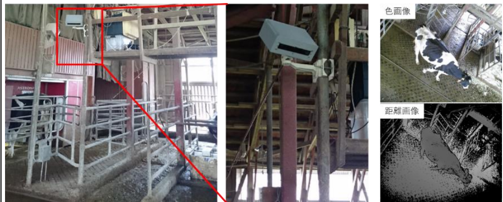
図 2 牛舎に設置された三次元形状計測用カメラと、撮影される画像例
