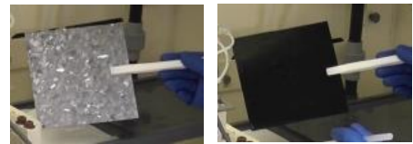
図1 開発した溶液処理（化学的転写法）による多結晶シリコンウェーハの極低反射化
