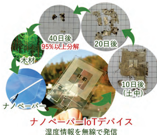
図 2 土中で総体積の 95%以上が分解されるナノペーパーIoT デバイス
