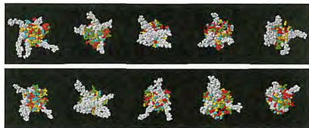
図 3 MD 計算によって得られた化学増幅型レジスト構造の一例 (白: ポリマー、赤:DTS、黄緑: 酸発生剤、黄緑: クエンチャー)
