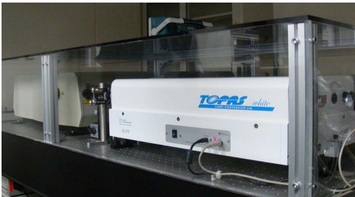
Fig.9 超短レーザーパルス発生装置 (Non-collinear Optical Parametric Amplifier: NOPA)
