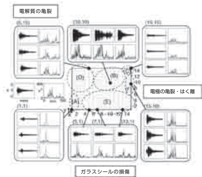
自動的に類似損傷事象进行分类し生成された可視化マップの例
