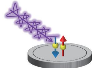
図1：光-スピン変換の概念図。光子の偏光状態から電子スピン状態へ変換する。
