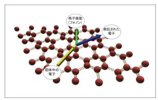
電子格子相互作用などの擾乱を調べるためには、励起光の波長や偏光などを自由に制御し、しかも明るく高分解能 (<10meV) で測定しなければなりません。このため、シンクロトロン放射光施設を利用し、多くの他機関の研究者とも連携して研究を進めています。さらに、高分解能電子エネルギー損失分光 (HREELS) や、電子電子コインシデンス分光法(EECOS)など、先進的なさまざまな電子分光法も用いています。
