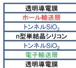
トンネルSiO 2 パッシベーション膜を有したヘテロ接合結晶シリコン太陽電池の構造
