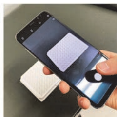
図1. 化学発光タンパク質を利用したバイオセンサーによる血中成分の検出。右上. BABIによるビリルビンの検出。ビリルビンの濃度に応じて、血液を通した発光色が青から橙に変化する。スマートフォン搭載のカメラで撮影し、色成分を解析することで濃度が計算できる。右下. Thrombastorによるトロンビンの検出。トロンビンの濃度に応じて、発光色が緑から青に変化する。
