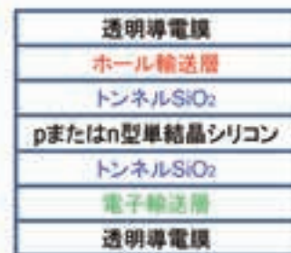
トンネルSiO 2 パッシベーション膜を利用したヘテロ接合結晶シリコン太陽電池の構造
