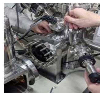
ゲートバルブの交換
