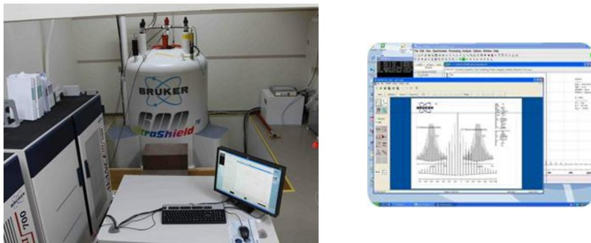
ブルカーバイオスピンの最先端固体 NMR の AVANCE III 600WB はワイドボアの磁石をもつ、-140~+150°C の範囲内での測定が可能です。さらに4mm CPMAS プローブ、超高速回転型の 1.3 mm CPMAS プローブと組み合わせて、プロトン、多核、二次元まで従来測定が困難なものも、測定が可能です。これらによって、材料化学、固体触媒の解析から生命科学まで幅広い分野にご使用頂ける最高水準の固体 NMR 装置です。
