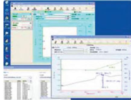
熱分析は、試料を加熱、冷却した際の試料の物理的・化学的性質を温度または時間の関数として測定する一連の技法であり、主に材料の反応温度や反応量などを調べる場合に利用されます。TG8120 は水平差動型 TG と DTA の同時測定装置であり、試料の重量変化および熱エネルギー変化を測定できます。DSC8230 と DSC8270 は、いずれも熱流束型 DSC であり、試料内に発生する熱エネルギーの変化を測定します。温度制御範囲は、TG8120 は室温から 1250℃まで、DSC8230 は-125℃(要液体窒素)から 450℃まで、DSC8270 は室温から 1500℃までです。
