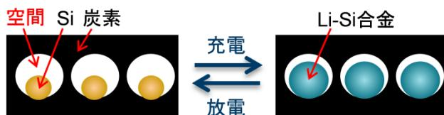
図 1 Si 負極材料の劣化を防ぐ方法①
