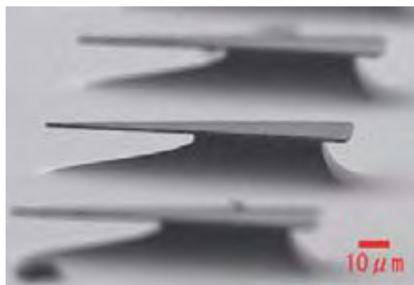
図2 シリコン酸化膜浮構造
