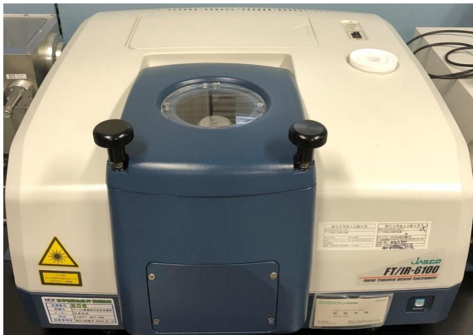
マイケルソン干渉計による光強度のフーリエ変換により、近赤外～遠赤外の吸収スペクトル等を計測できる装置。赤外領域にある振動・回転吸収スペクトルにより、有機分子等の化学式・構造・状態の同定が可能。
