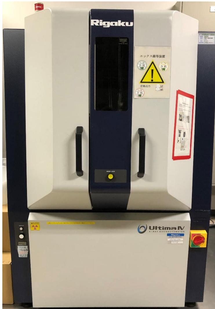
インプレンスキャンによる面内構造解析に特化した仕様でありながら、感度の低下があるもののそのままでも面外回折測定も行える汎用性の高い装置です。アタッチメントを変更すると、高感度での面外回折測定も可能となります。
