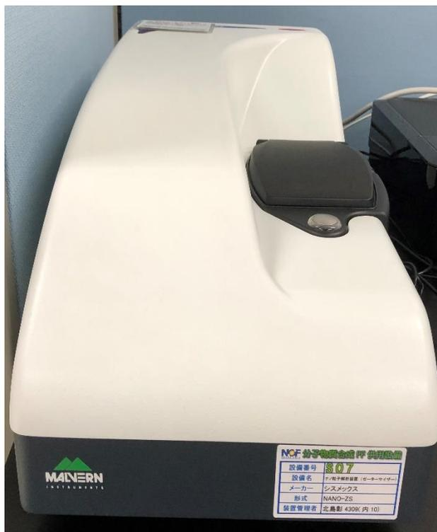
0.1ppm の超希薄系から 40wt% の濃厚系で、最小 12 $\mu$ l の微量サンプル中のナノ粒子径を動的光散乱法では 0.6 nm $\sim$ 6 $\mu$ m の範囲、ゼータ電位測定法では 3nm $\sim$ 10 $\mu$ m の範囲で高精度に測定し評価する装置。
