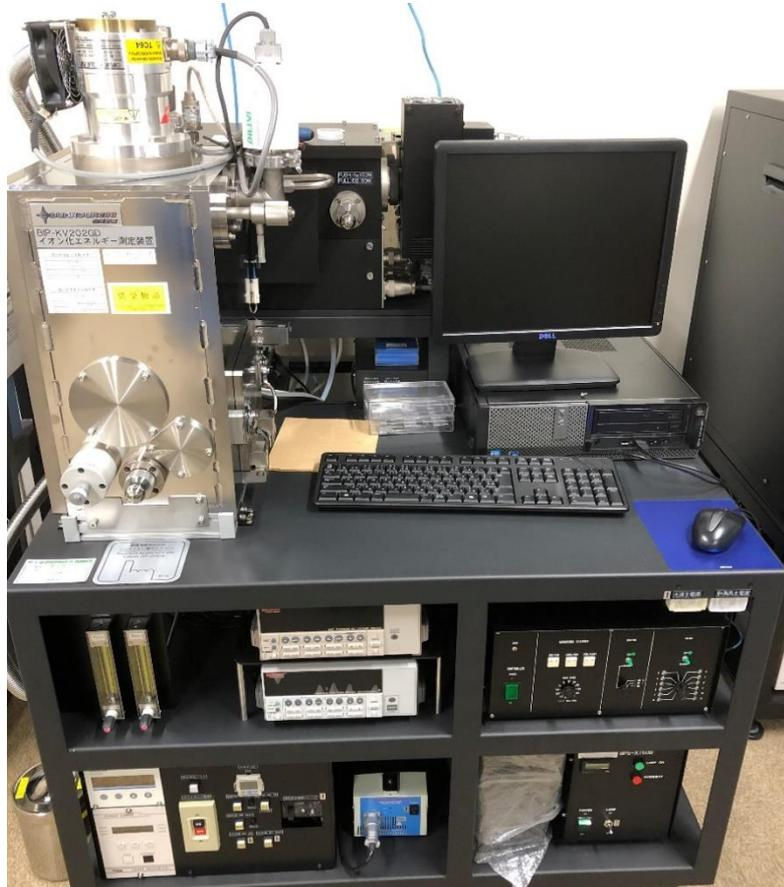
大気・窒素・真空雰囲気下で、有機半導体や金属薄膜のイオン化エネルギーの測定ができます。
