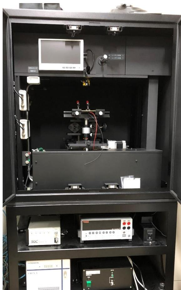
太陽電池や光電交換素子などの試料にレーザー光をスキャニング照射し、電流密度を測定する装置。光電流マッピング可能
