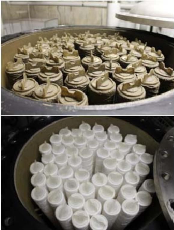
図 2 フィルタータンク内部の状態。(上)交換前、
