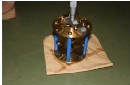
図5 ナイロン製支柱が絶縁破壊した放電球。
