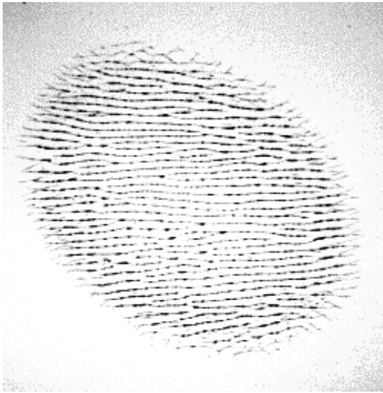
図2. 集光した THz-FEL による Si 表面の LIPSS 構造
