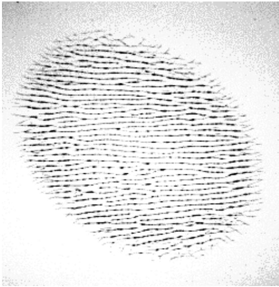
図2. 集光した THz-FEL による Si 表面の LIPSS 構造
