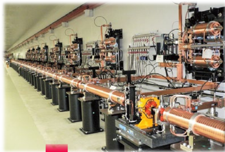
SACLAの C-band主加速管システム
