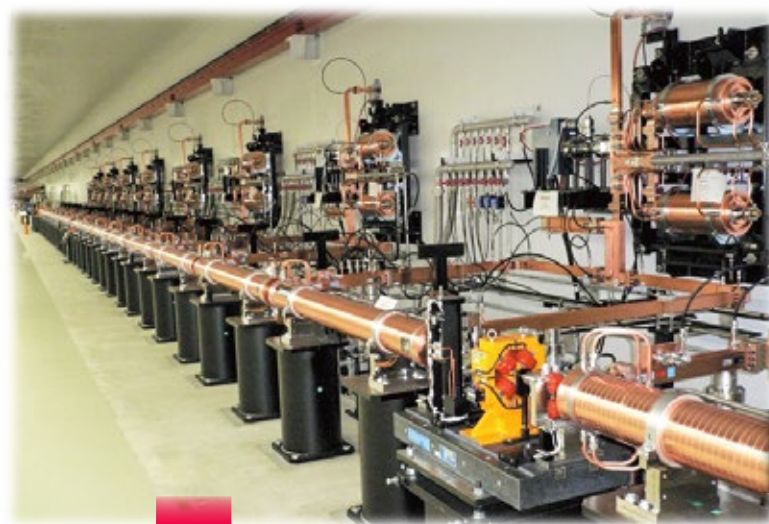
SACLAの C-band主加速管システム
