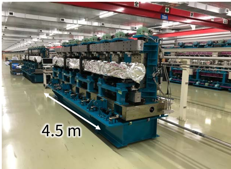
旧SCSSアンジュレータ（真空封止型） > 10,000 kg
