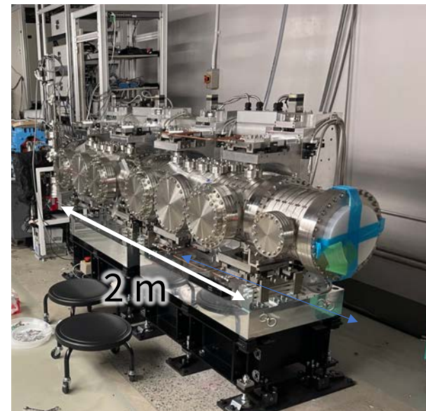
磁場吸引力相殺型 < 500 kg 駆動機構、架台が軽量化
