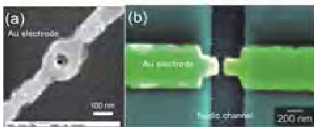
図 2 (a)サラウンドゲート及び(b)制御電極が付いた In-plain 型ナノポアデバイスの SEM 像。サラウンドゲートの中央ではナノポアが基板裏側まで貫通している。
