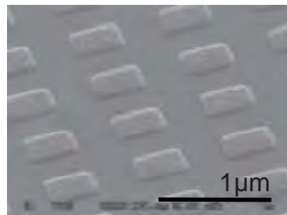
図1 (\text{Fe,Zn})_3\text{O}_4 ナノドットパターンのSEM像。
