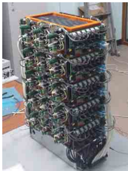
図1 SIサイリスタを用いたクライストロンモジュレータ用半導体スイッチ。
